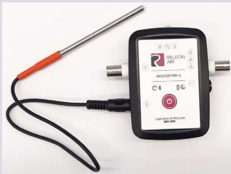
Рис. 6. Датчик температуры растворов
